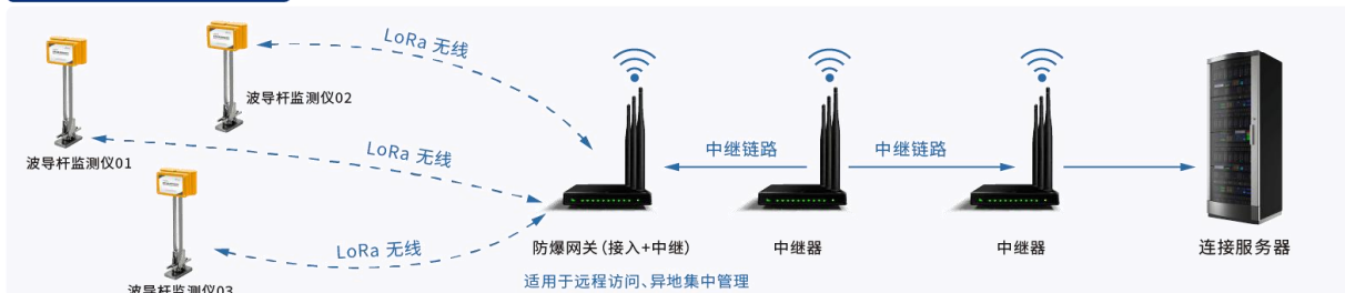
图 1. CST1670 超声波高温腐蚀监测仪通信方式框图
