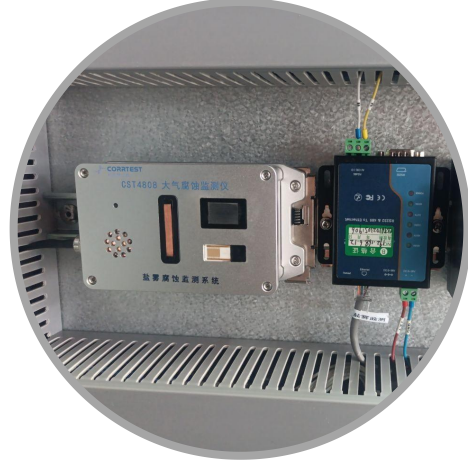
大气腐蚀监测仪用于监测机房内大气环境对 Cu 金属腐蚀监测
