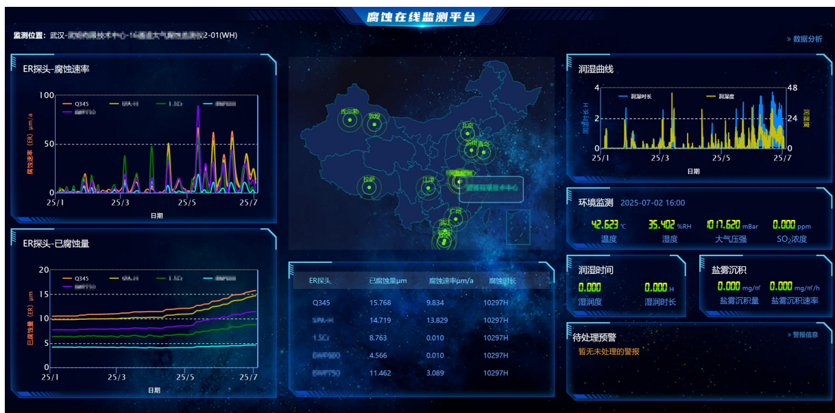
大气腐蚀监测仪用于暴露大气环境对多种金属腐蚀监测
