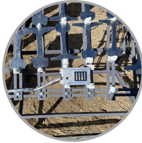
大气腐蚀监测仪用于暴露大气环境对多种金属腐蚀监测
