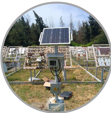
大气腐蚀监测仪用于暴露大气环境对多种金属腐蚀监测
