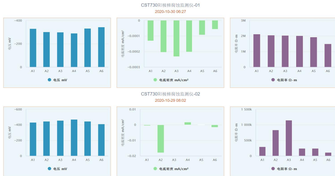
图 5. 阳极梯监测的钢筋自腐蚀电位、钢筋阻抗和电偶电流监测数据
